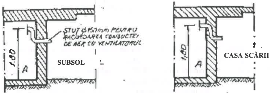
Figura nr. 10 Priza de aer din casa scării sau subsolul clădirii (model)
