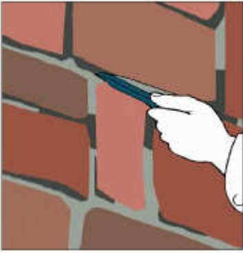
Fig. 7 - Curățarea rosturilor zidăriei și repararea rosturilor cu mortar
