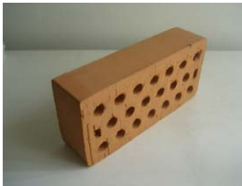
Figura 19.2 – Exemplu de cărămidă semiplină 15\% < \phi \leq 45\% din pământ ars pentru zidărie de susținere
