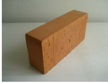
Figura 19.1 – Exemplu de cărămidă plină \phi \leq 15\% din pământ ars pentru zidărie de susținere
